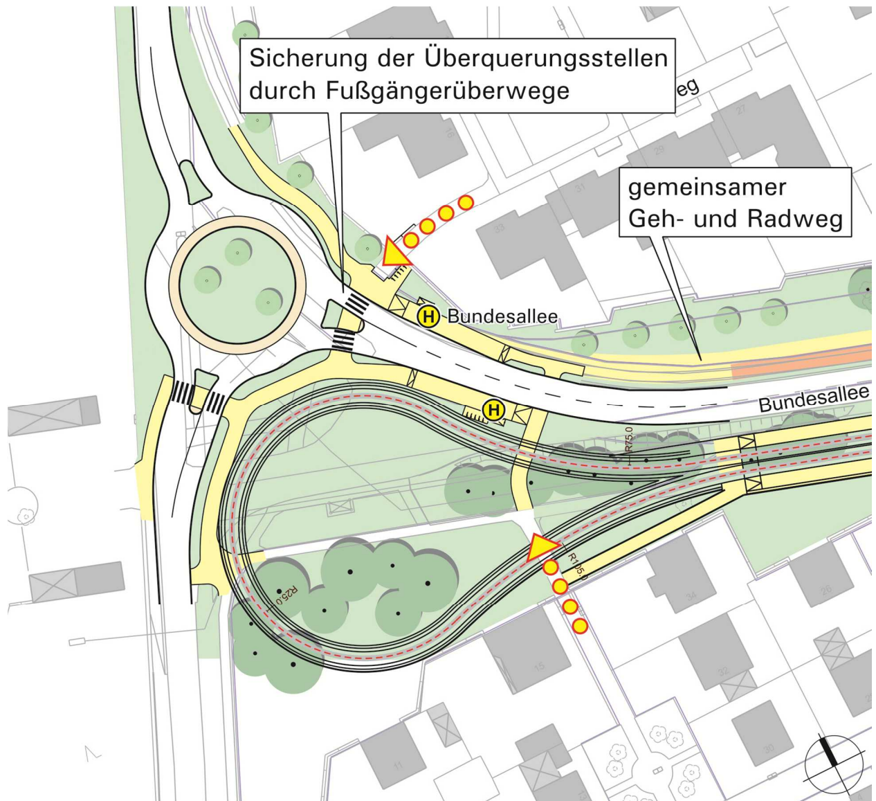
Abb. 32 Umgestaltung des Knotenpunktes zu einem Kreisverkehr mit Wendeschleife für die Stadtbahn (Planung Kreisverkehr: Stadt Braunschweig)
