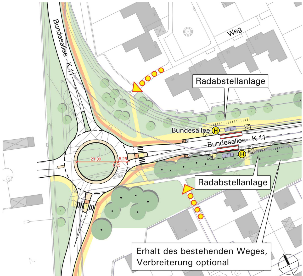
Abb. 33 Umgestaltung des Knotenpunktes zu einem Kreisverkehr; Querschnittsgestaltung Bundesallee (K 11) gemäß Variante 3a
