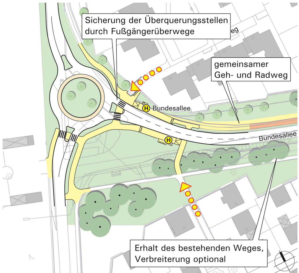
Abb. 31 Umgestaltung des Knotenpunktes zu einem Kreisverkehr (Planung Kreisverkehr: Stadt Braunschweig); Querschnittgestaltung Bundesallee (K 11) gemäß Variante 2a
