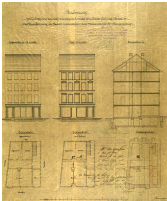
Abb. 46: Ansichten und Querschnitte des Hauses Bohweg Nr. 44 (Eigentümer: Malermeister: H. Banse) mit Kennzeichnung von baulichen Veränderungen aus der Bauakte des Gebäudes, 1902 (Stadtarchiv Braunschweig, E 63 II: 70 Akz. 2007/124).
