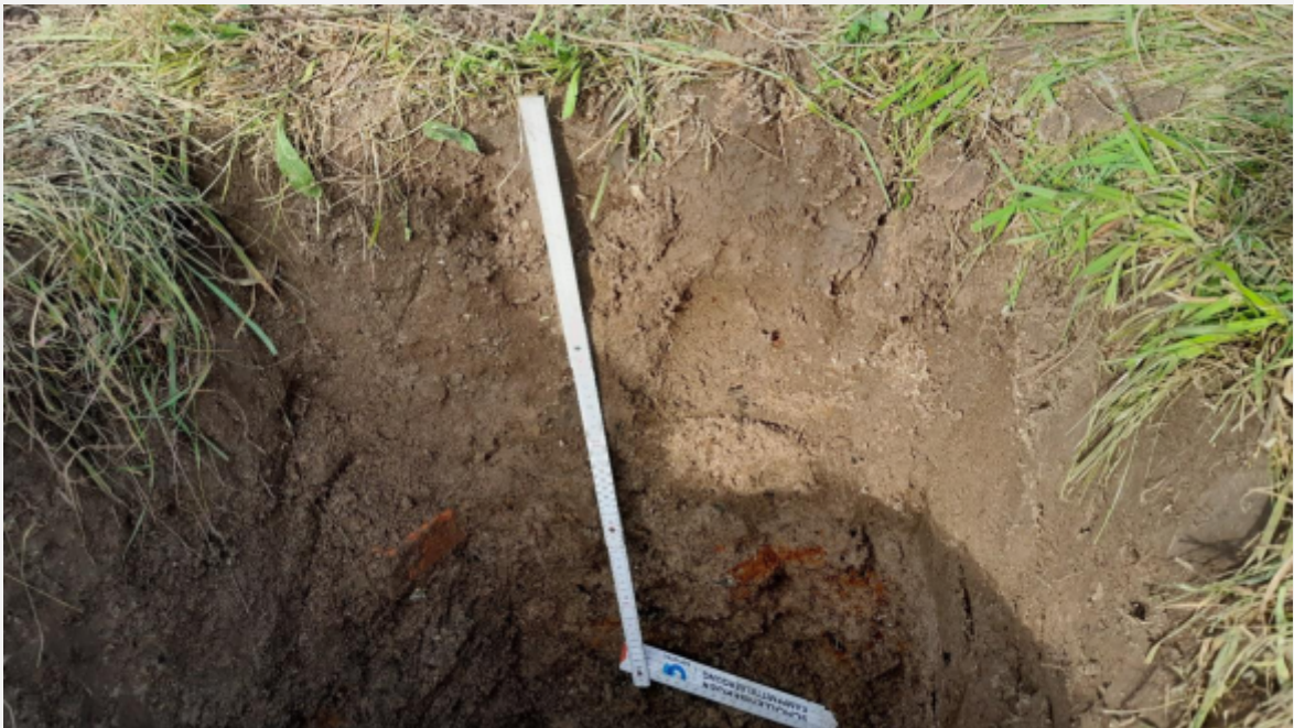
Foto 14 Handschürf HS-33 welcher im Bereich einer Auffüllung angelegt wurde. Aufnahme vom 11.10.2023.
