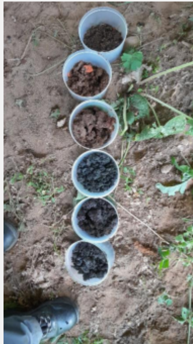
Foto 5 Horizontbezogene Probenahme Gut erkennbar sind die Ziegelsteinbruchstücke der Auffüllung. Foto vom 10.08.2023.
